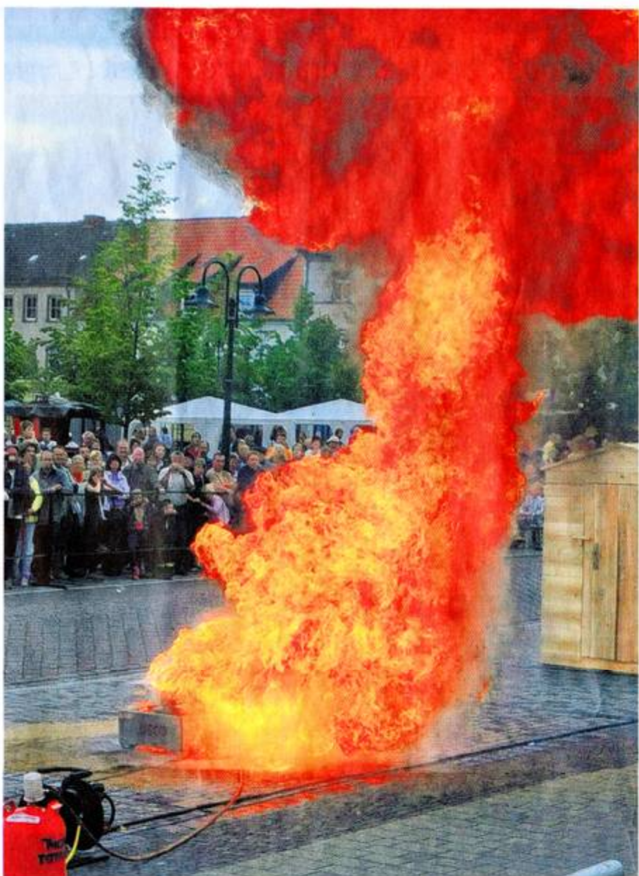
Inferno trotz Löscheinsatz: Lediglich ein halber Liter Wasser reicht aus, um diese meterhohe Flamme zu erzeugen. Demonstriert wurden die Folgen, wenn brennendes Fett in einer Pfanne falsch gelöscht wird. FOTOS: J. K. MÖLLER
